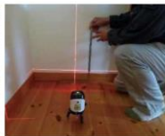
「床の積きを計測する」調査機器
