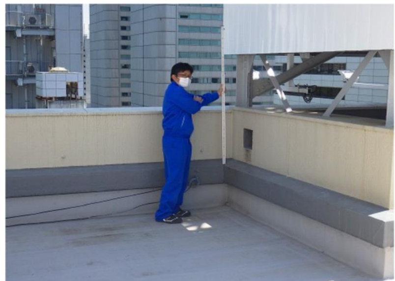
不同沈下測定状況(屋上パラペット天端)
